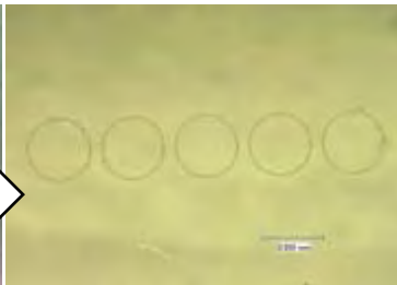
石英レンズへの微細マーキング(直径0.5mm)
