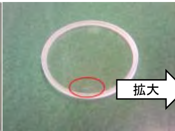
石英レンズへの微細マーキング(直径0.5mm)
